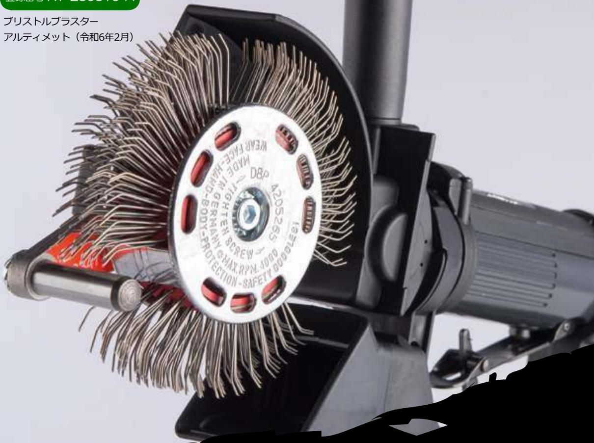
モンティパワーブリストルブラスター®はブラスト面形成工具で、Sa2 1/2(SSPC-SP10、NACE No.2)からSa3(SSPC-SP5、NACE No.1)までの素地調整が可能です。粗度120µm (4.72mil) Rz相当で均質に施工します。
