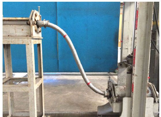
沈下試験装置
