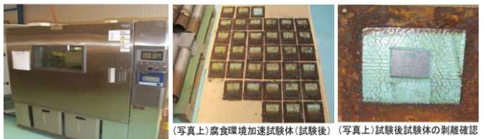
(写真上)腐食環境加速試験体(試験後) (写真上)試験後試験体の剥離確認
