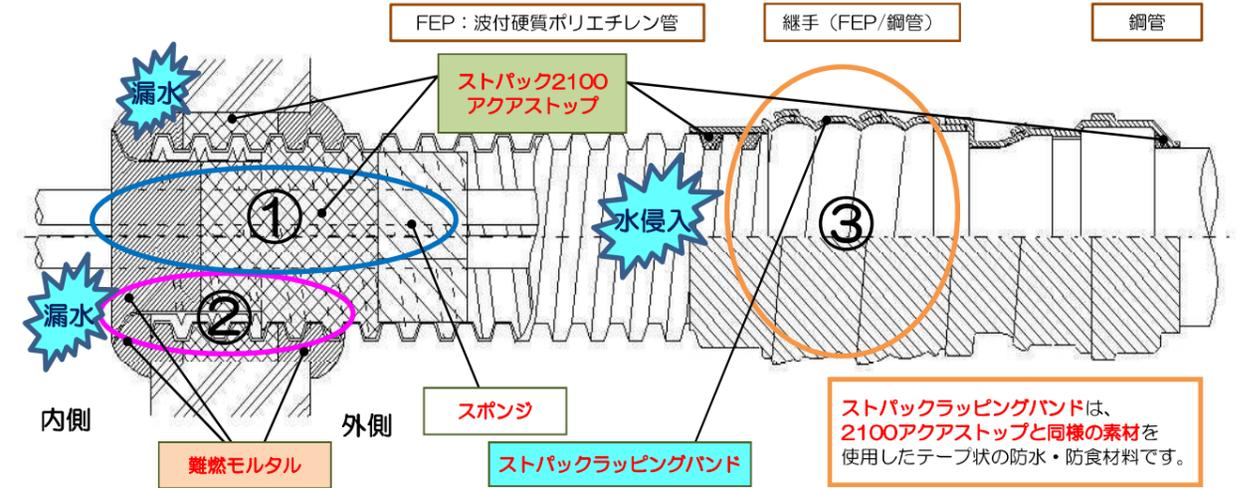
ストバックラッピングバンドは、2100アクアストップと同様の素材を使用したテープ状の防水・防食材料です。
